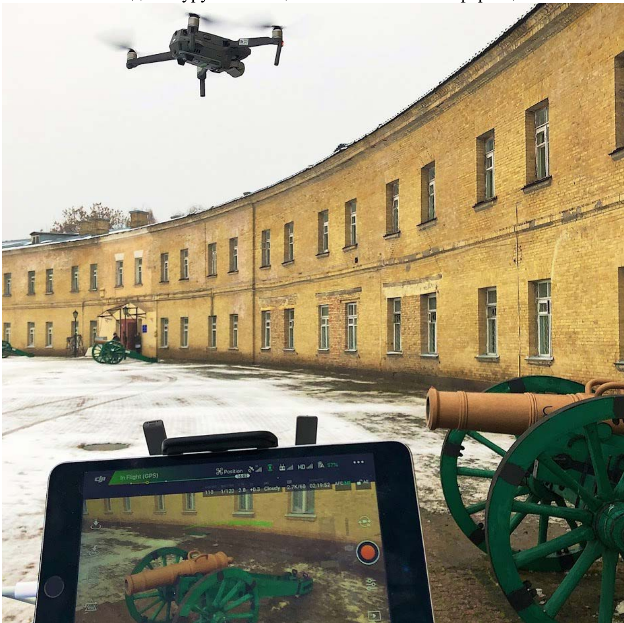
Процес зйомки гармати з квадрокоптера для створення її 3D моделі
